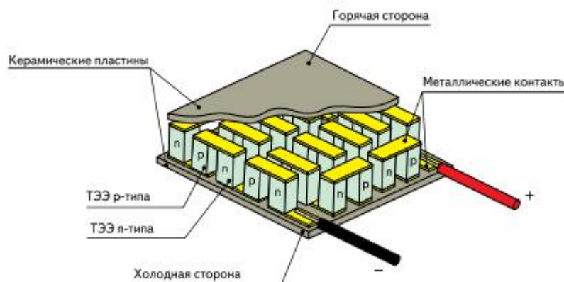
Рисунок 4 - Термоэлектрический генераторный модуль в разрезе [1, с. 134]
