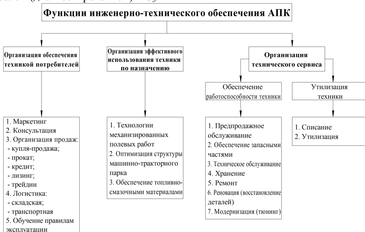
Рисунок 1 – Технический сервис в системе инженерно-технического обеспечения агропромышленного комплекса
