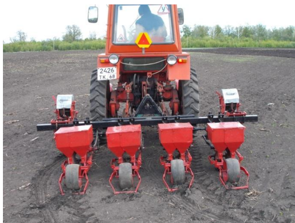
Рисунок 1 – Общий вид и посевная секция модернизированной свекловичной сеялки
