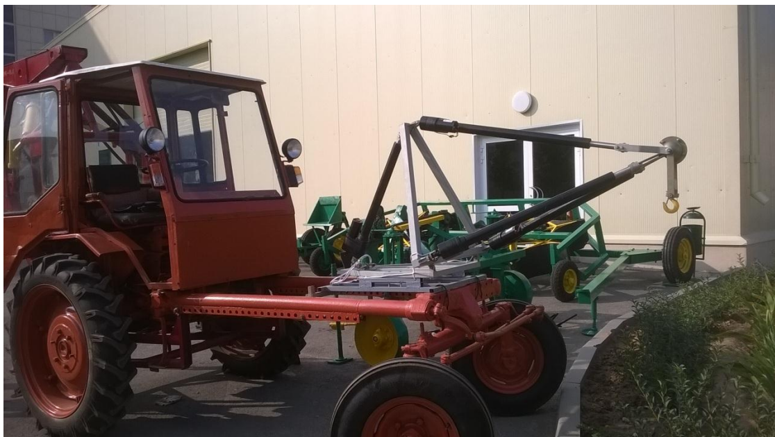
Рисунок 2 – Манипулятор трипод на подвижном основании с исполнительными звеньями-электроцилиндрами
