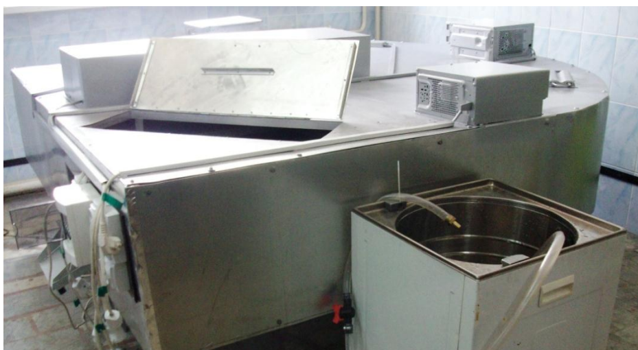
Рисунок 3 – Опытный образец установки для термообработки кровяных изделий из крови убойных животных
