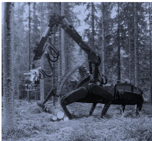
Рисунок 3 – Шагающий трактор Джон Дир
