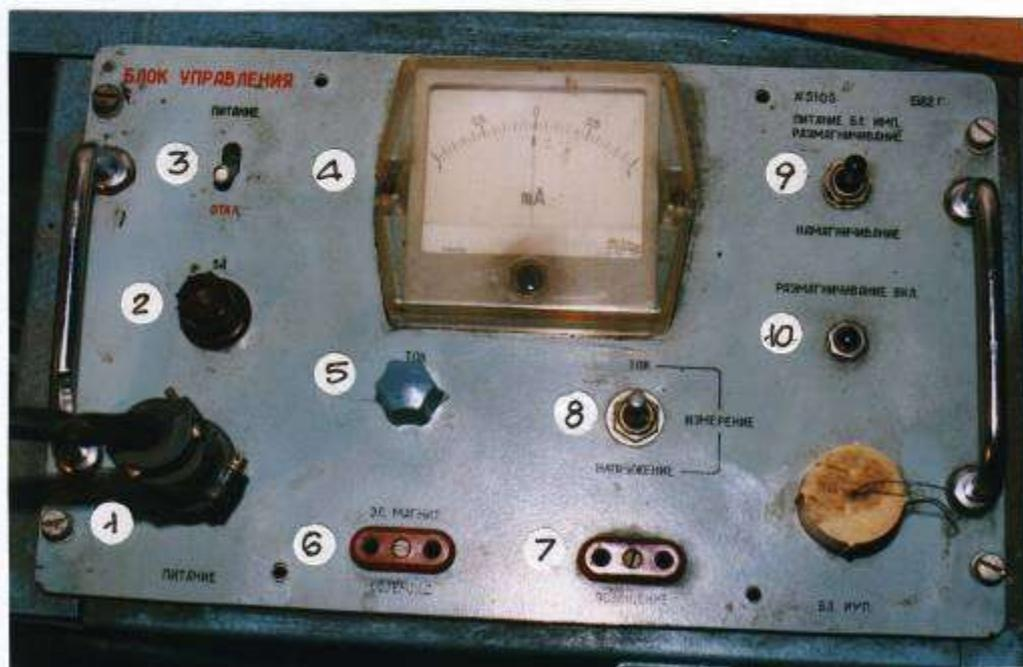
1 – кабель подключения питания блока управления; 2 – предохранитель; 3 – тумблер включения питания; 4 – миллиамперметр; 5 – регулятор силы тока; 6 – гнездо подключения соленоида; 7 – гнездо подключения местного освещения; 8 – переключатель режима измерения параметров; 9 – переключатель режима работы блока управления; 10 – кнопка включения начала размагничивания
