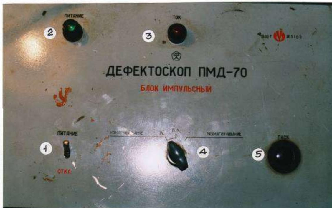
1 – тумблер включения питания; 2 – сигнальная лампочка «питания»; 3 – сигнальная лампочка о прохождении импульса тока в цепи; 4 – переключатель режимов работы дефектоскопа (намагничивание, размагничивание); 5 – кнопка для пропускания единичных импульсов тока (при работе с мелкими деталями)
