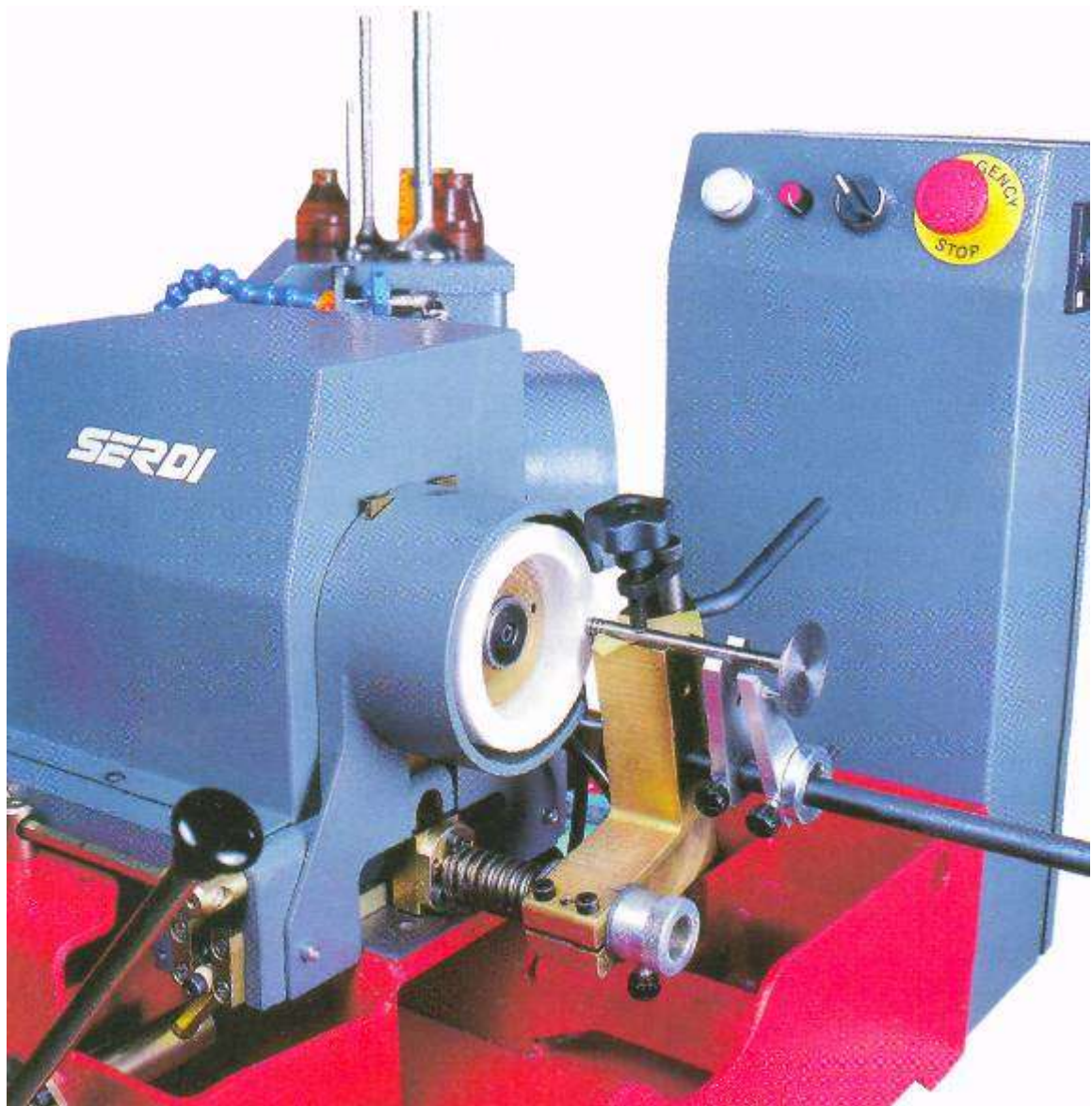
Рисунок 23.- Торец стержня и его фаску HVR поправит за считанные секунды.
