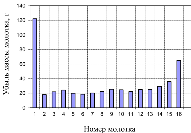
Рисунок 2 – Диаграмма износа молотков в зависимости от их расположения на роторе молотковой дробилки
