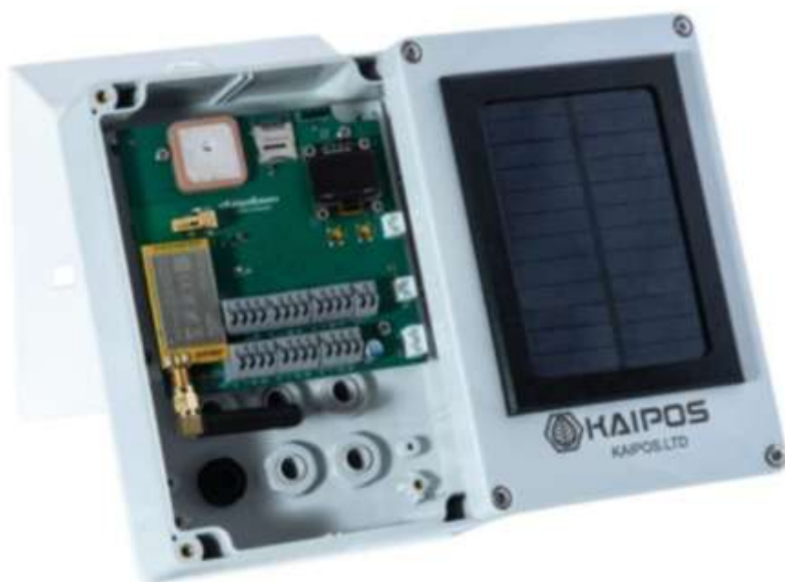
Рисунок 1 – Метеостанция с измерением давления KAIPPO BASE
