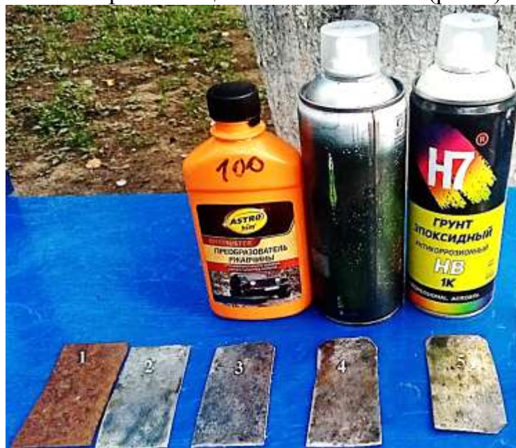
Рисунок 1 – Общий вид образцов для проведения исследований: 1- образец без обработки; 2 – механически обработанный образец; 3 – образец под покрытие преобразователем ржавчины и эмалью; 4- образец под покрытие эмалью; 5- образец под покрытие грунтом эпоксидным и эмалью.
