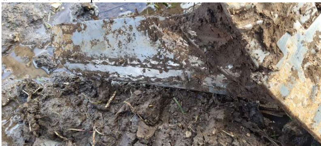
Рисунок 1 – Упрочненный крыльчатый лемех в процессе испытаний
