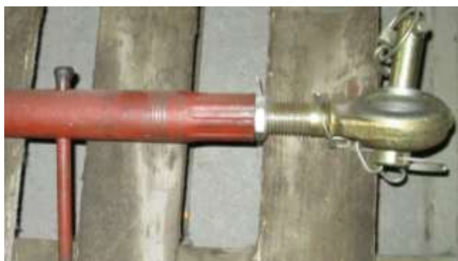
Рисунок 3 = Тяга центральной навески трактора МТЗ
