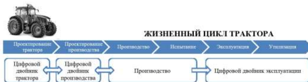
Рисунок 2 – Структура жизненного цикла цифрового двойника трактора
