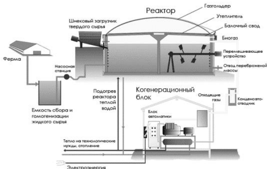
Рисунок 2 – Общая схема производства биогаза и работы биогазовой установки
