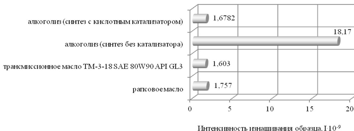
Рисунок 7 – Результаты определения интенсивности изнашивания неподвижного образца (шара) в присутствии полученных продуктов алкоголиза
