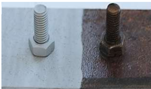
Рисунок 4 –Антикоррозионный слой, нанесенный порошком А-80-13 методом ХГДН
