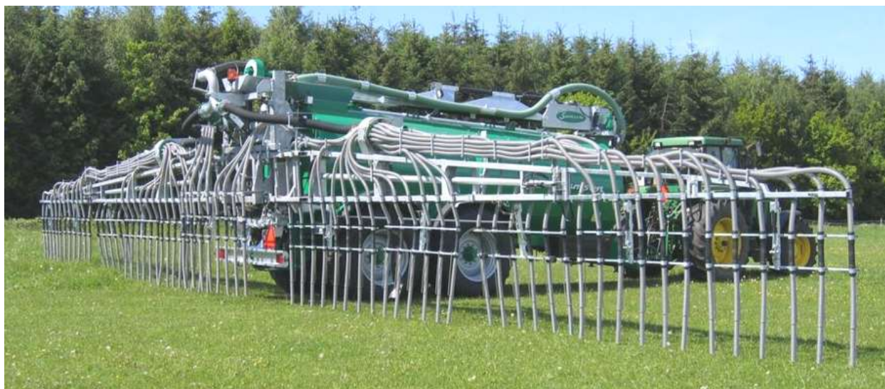
Рисунок 1 – Машина для внесения жидких органических удобрений по технологии Dribble-bar
