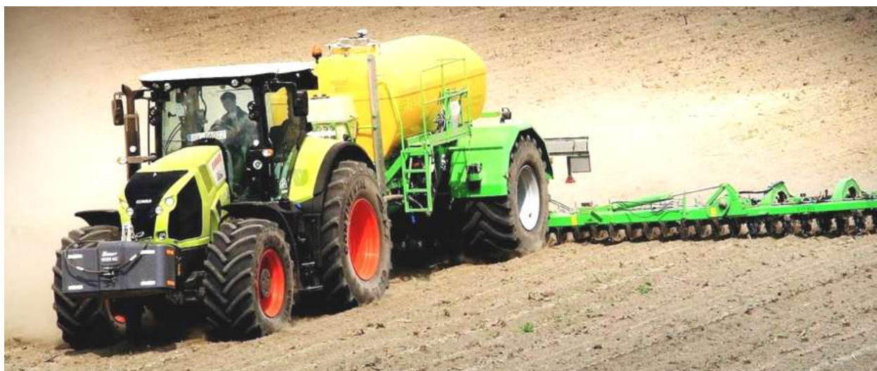
Рисунок 5 – Агрегат GFI фирмы Güstrower для внесения органики по технологии Cultan
