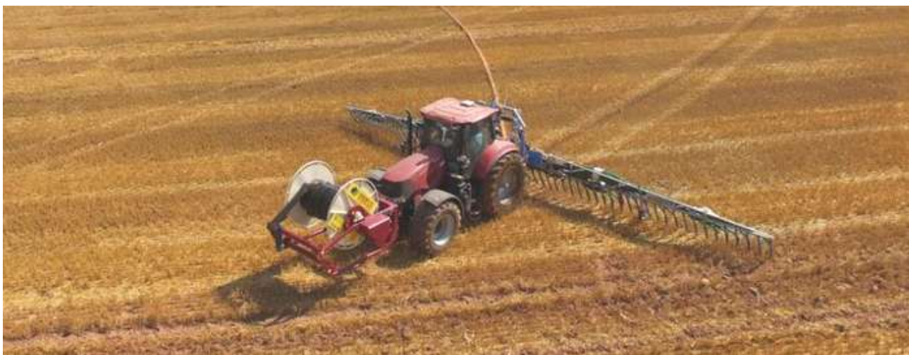
Рисунок 2 – Машина для внесения жидких органических удобрений по технологии Trailing shoe.
