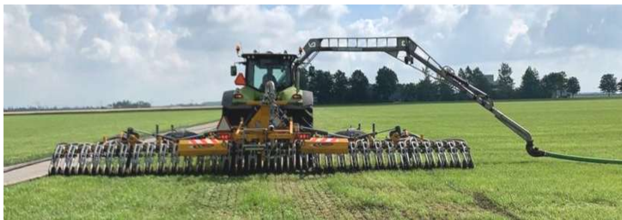
Рисунок 3 – Внесение жидкой органики при помощи одно- или двухдисковых сошников с растениями на полях.
