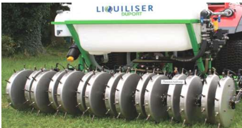
Рисунок 4 – Машина для точечного внесения жидкой органики – Liquliser фирмы Dupont (Нидерланды).
