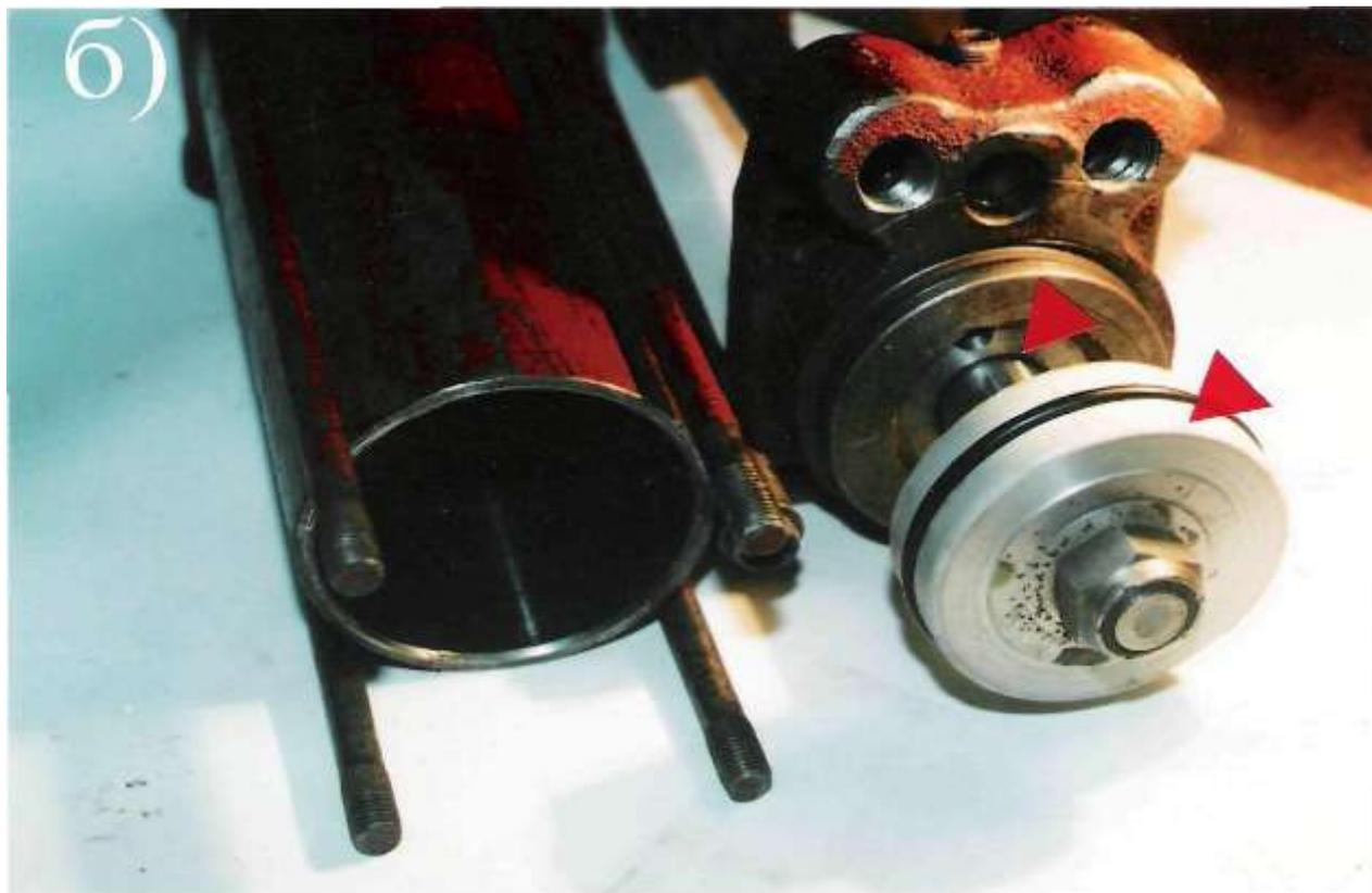
Рисунок 14.- Примеры использования износостойких антифрикционных полимерных композиций для восстановления деталей гидроагрегатов:
