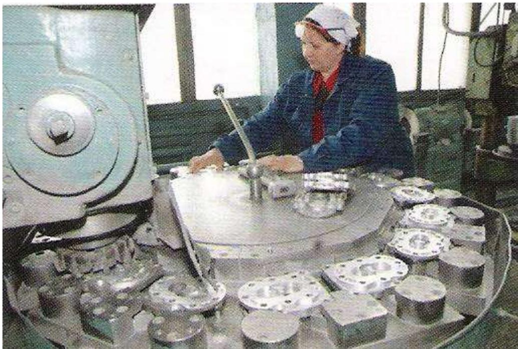
Рисунок 13. – Обработка крышек НШ по плоскости разъема с корпусом.
