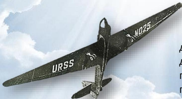
Самолет был выполнен по схеме моноплана с дюралевым гофрированным крылом необычного для того времени удлинения. Размер крыла позволял разместить в нем дополнительное горючее – более 7 тонн.
