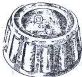
Рисунок 7.3.- Поверхность внутреннего кольца конического подшипника, подвергшаяся фреттинг-коррозии..
