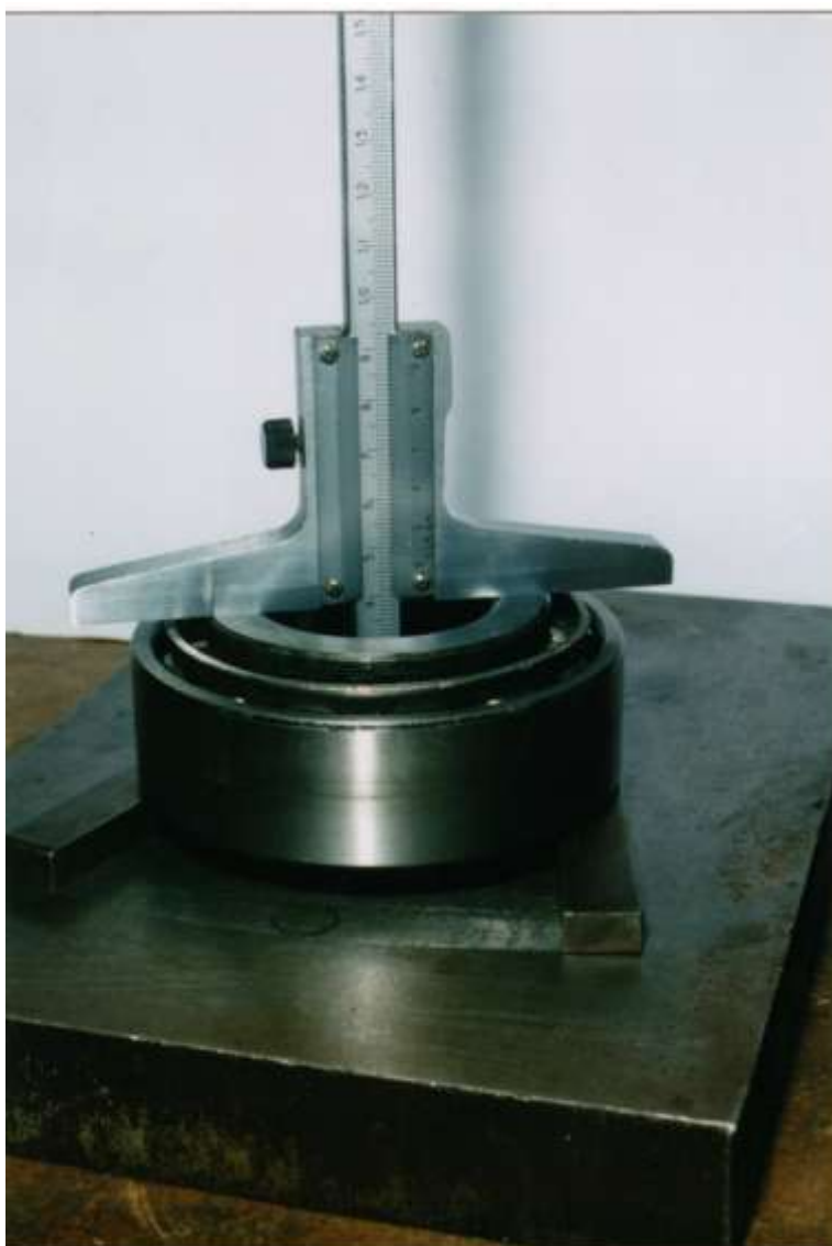
Рисунок 7.4.- Контроль монтажной высоты при помощи штангенглубиномера.
