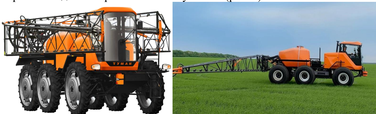
Рисунок.4 - Модернизированный самоходный опрыскиватель «Туман-3» последней модификации
