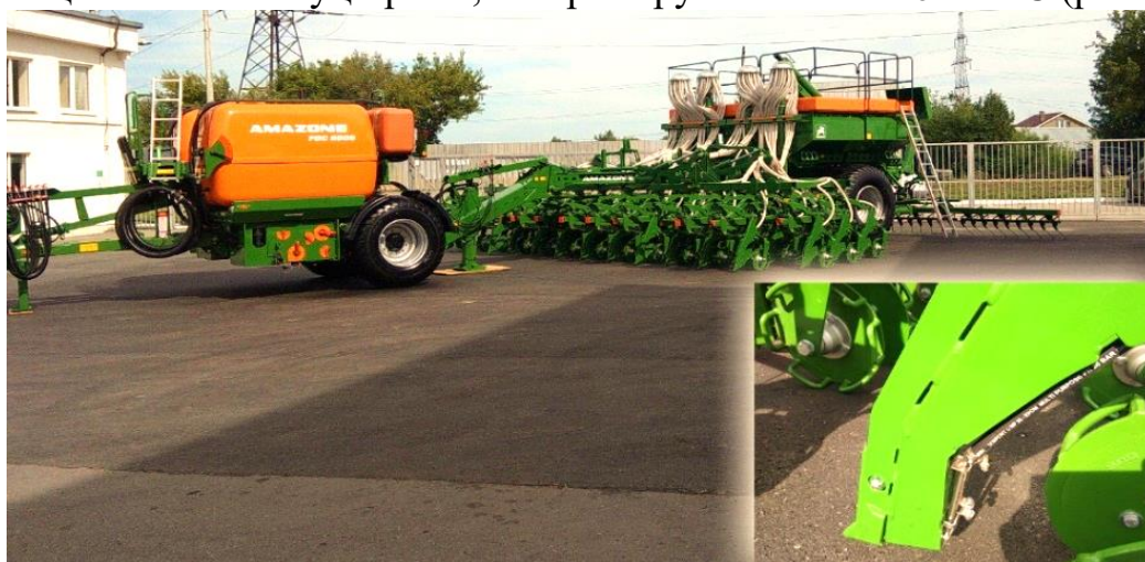
Рис. 3. Сеялка Primer DMC с долотовидными сошниками, оборудованными для внесения КАС
