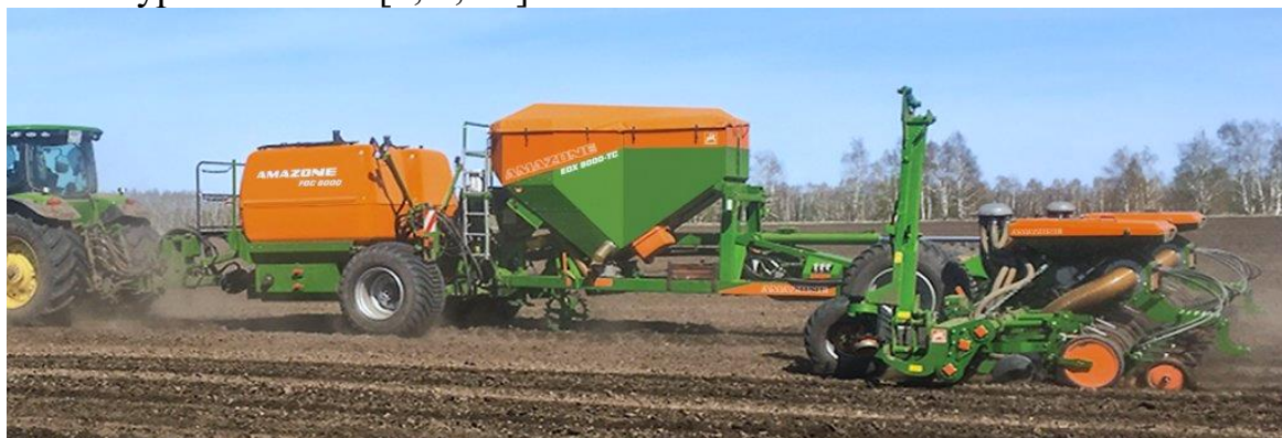
Рис. 4. Агрегат FDC-6000 с EDX 9000-ТС для посева подсолнечника и кукурузы одновременно с внесением жидких-КАС и твердых минеральных удобрений
