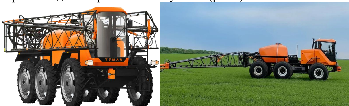
Рисунок.4 - Модернизированный самоходный опрыскиватель «Туман-3» последней модификации
