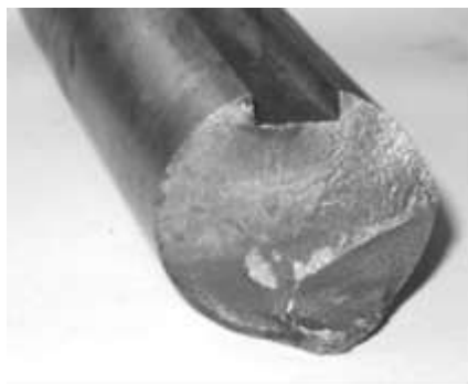
Рисунок – 1 Усталостный излом вала, возникший при умеренных напряжениях
