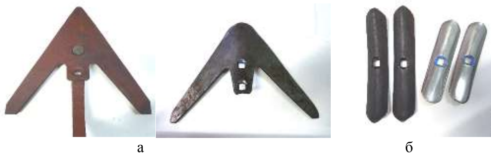
Рисунок 1 – Результат абразивного изнашивания стрелчатых (а) и долотообразных (б) лап культиваторов.
