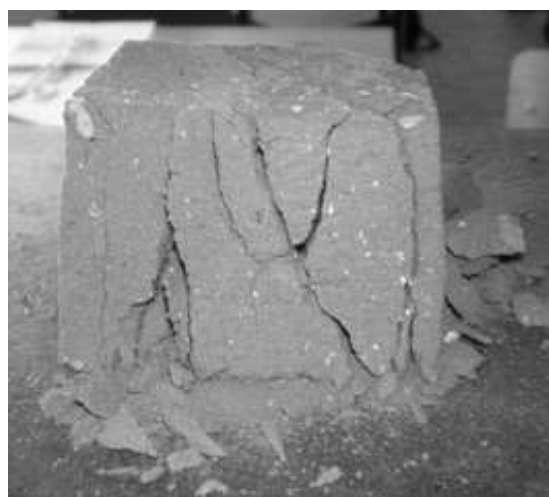
Рисунок 3 – Разрушение образцов, изготовленных из бетона при T=25 °С
