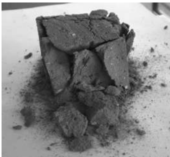
Рисунок 4 – Разрушение образцов, изготовленных из бетона при T=500\text{ }^{\circ}\text{C}
