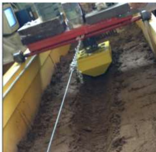
Рисунок 1 – Определение тяговых усилий при работе модели ковша каналоочистителя
