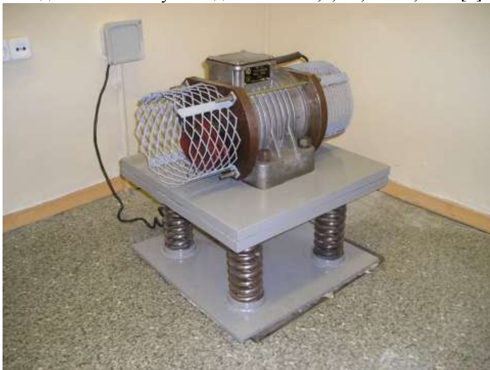
Рисунок 1 – Стенд для испытаний подшипниковых узлов при циклическом нагружении
