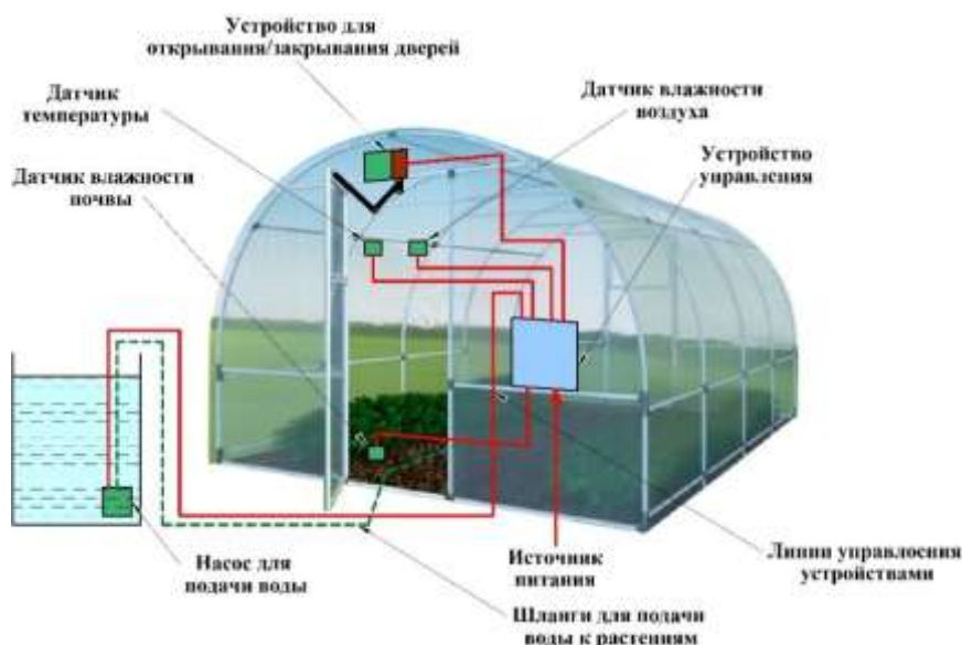
Рисунок 7 – Размещение элементов системы дистанционного управления в теплице
