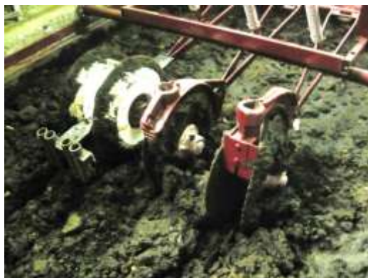
Рисунок 1 – Работа предлагаемых (слева) и традиционных (справа) бороздообразующих устройств в переувлажненной почве
