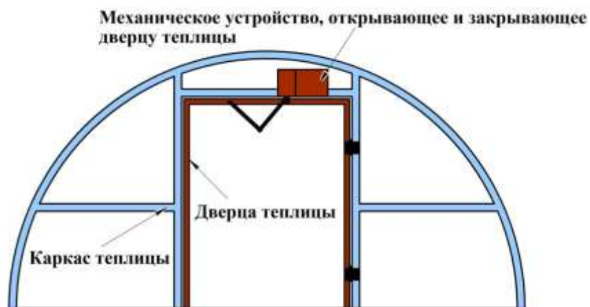
Рисунок 3 – Крепление устройства приводящего в движение дверцы теплицы
